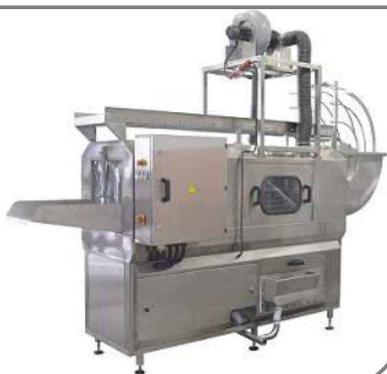
Пример за машина с обръщач и вентилационна система, арт. номер 2000602259
